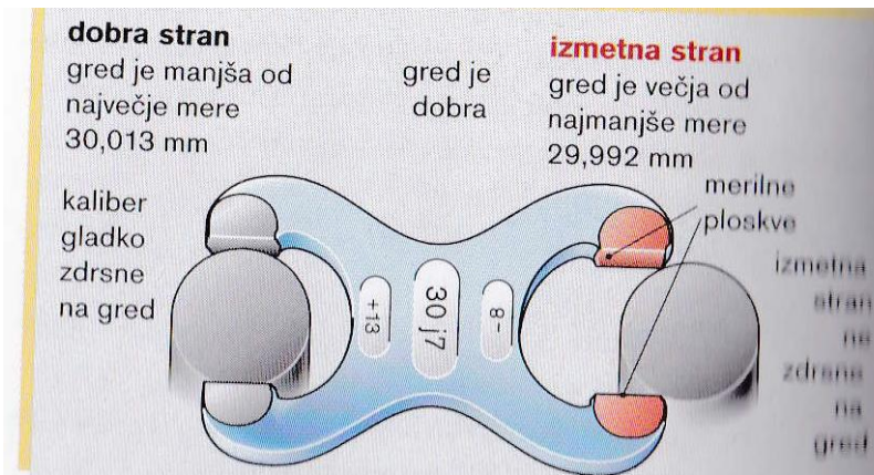
Slika 3: Zevni kaliber za toleranco čepa 30 j7
